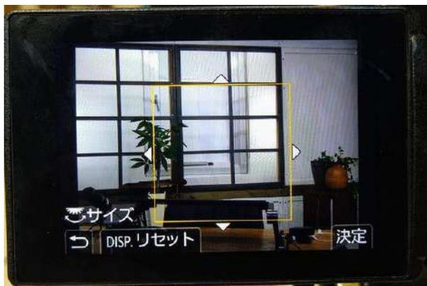
⑧ピントを合わせるため、画面を直接触り、決定ボタンを押してセットします。
